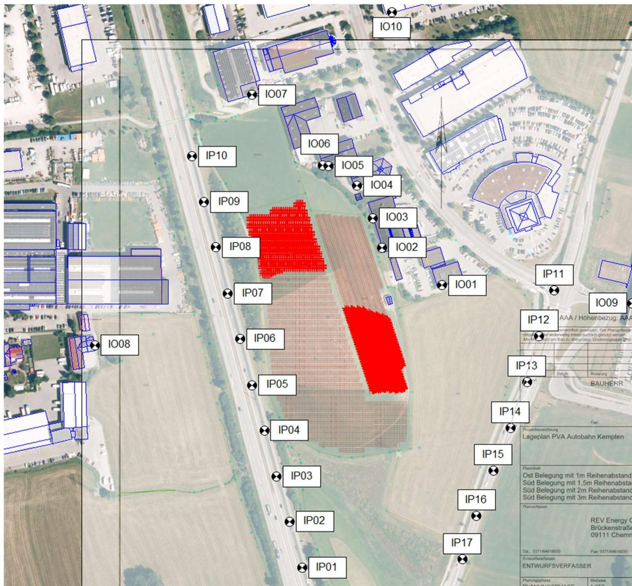
Abb. A7: Geplante Solaranlage mit Darstellung der Quellbereiche mit potentiellen Reflektionen am IP11
