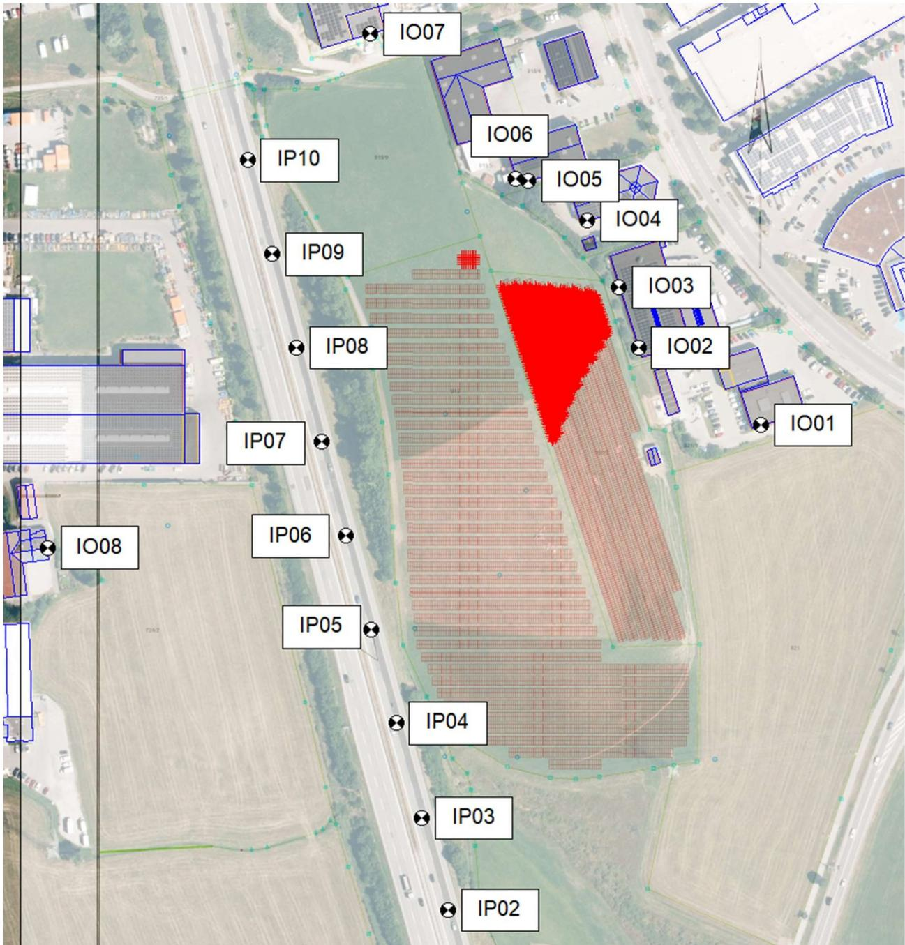
Abb. A13: Geplante Solaranlage mit Darstellung der Quellbereiche mit potentiellen Reflektionen am I03
