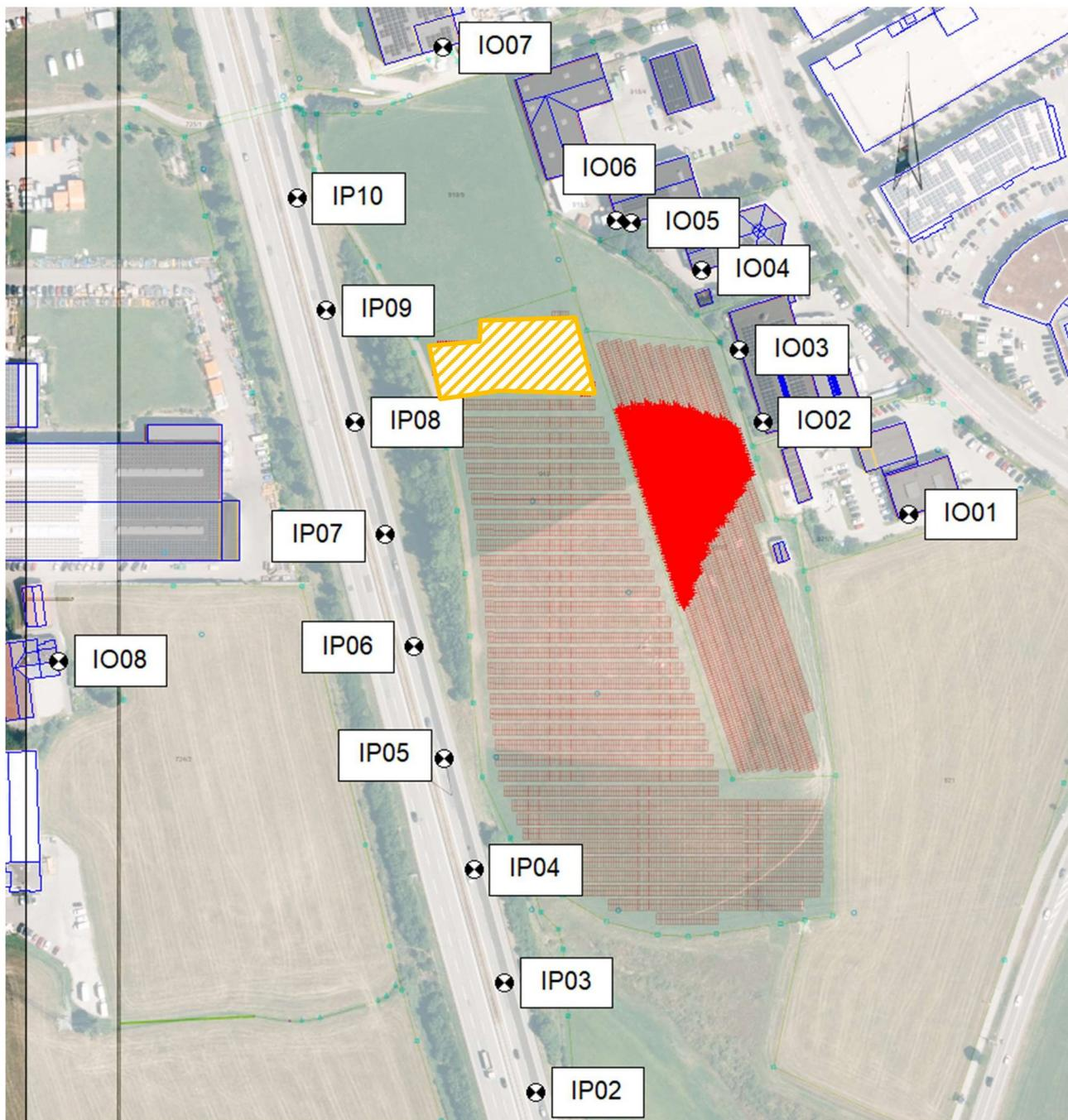
Abb. A12: Geplante Solaranlage mit Darstellung der Quellbereiche mit potentiellen Reflektionen am IO2
