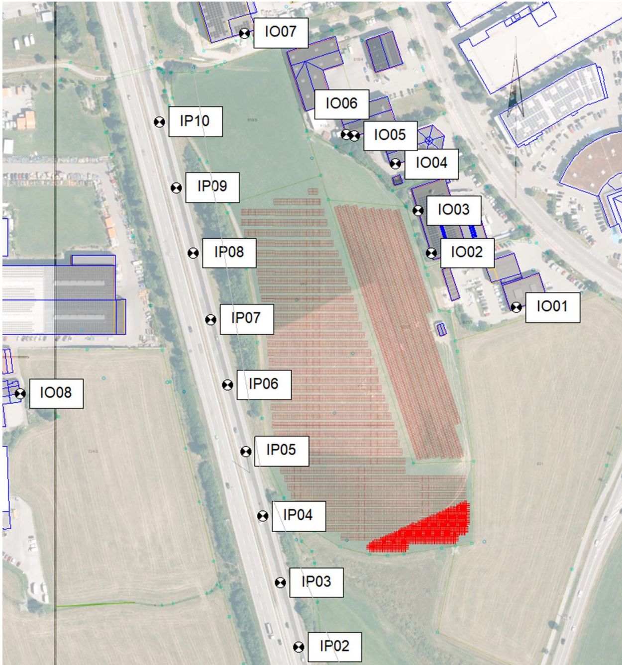
Abb. A1: Geplante Solaranlage mit Darstellung der Quellbereiche mit potentiellen Reflektionen am IP3
