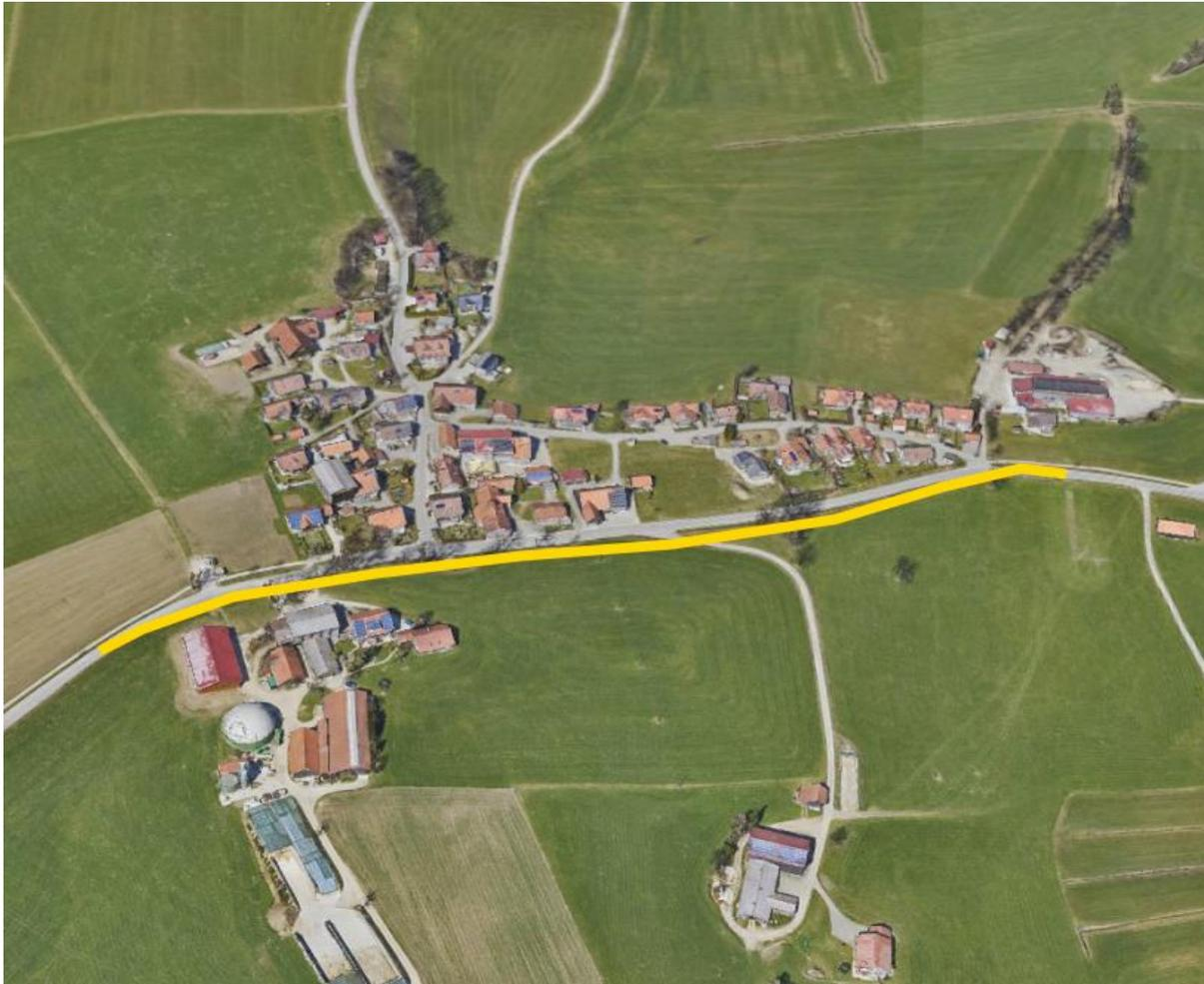
Erneuerung der Straße aufgrund von gravierenden Sicherheitsmängeln. Vorgesehen sind Abbiegespuren, Querungshilfen sowie Fuß- und Radwege
