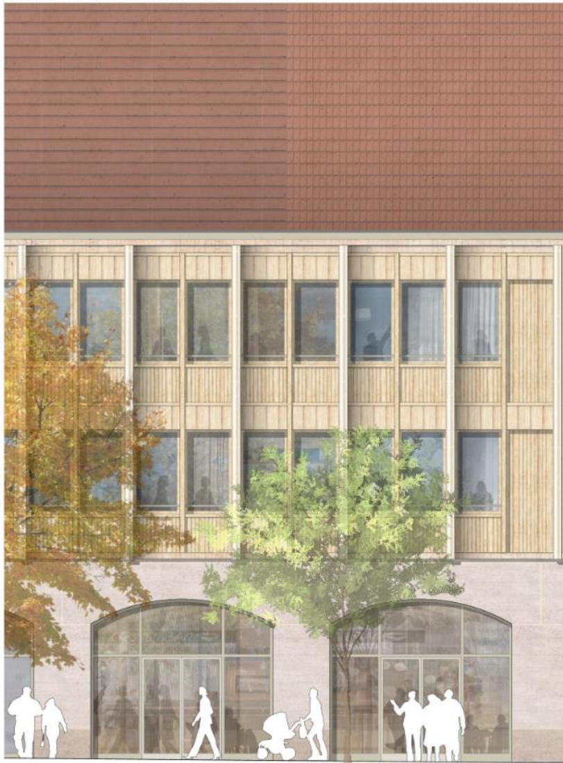
Südsseite Dach: integrierte Solarmodule in roter Ziegeloptik
