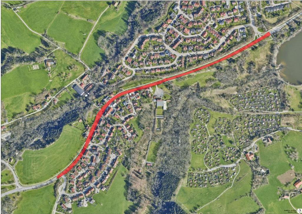
Vorgesehenes Baufeld. Teilweise Erneuerung der Binderschicht. Komplette Erneuerung der Deckschicht und Markierung. Umfang der Gehweginstandsetzung in Abhängigkeit der Arbeiten der Sparten. Baubeginn ist an der Stadtgrenze im Westen.
