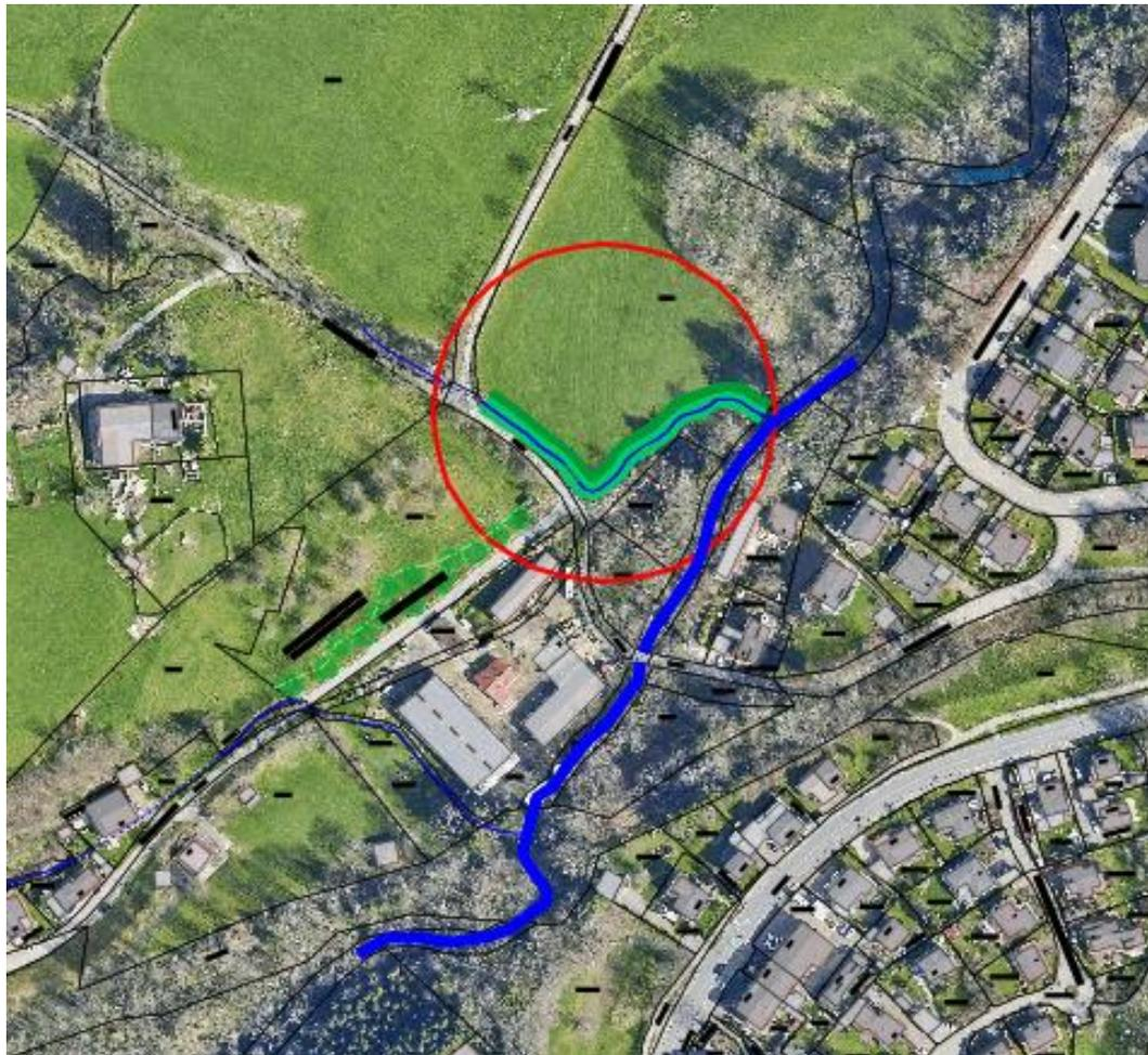
Als Ausgleichsmaßnahme für den neu gebauten Radweg in Rothkreuz bei der Pulvermühle soll der Bach, der hier vor der Verrohrung immer wieder rückstaut, geöffnet und naturnah verlegt werden
