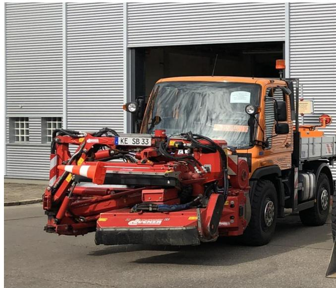
Böschungsmähgerät aus 2020
