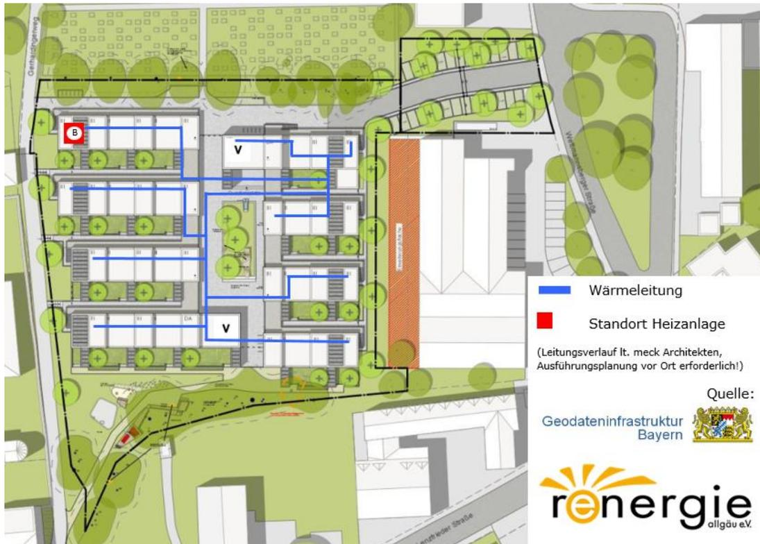
Abbildung 7 Leitungsschema Pellets-Heizanlage
