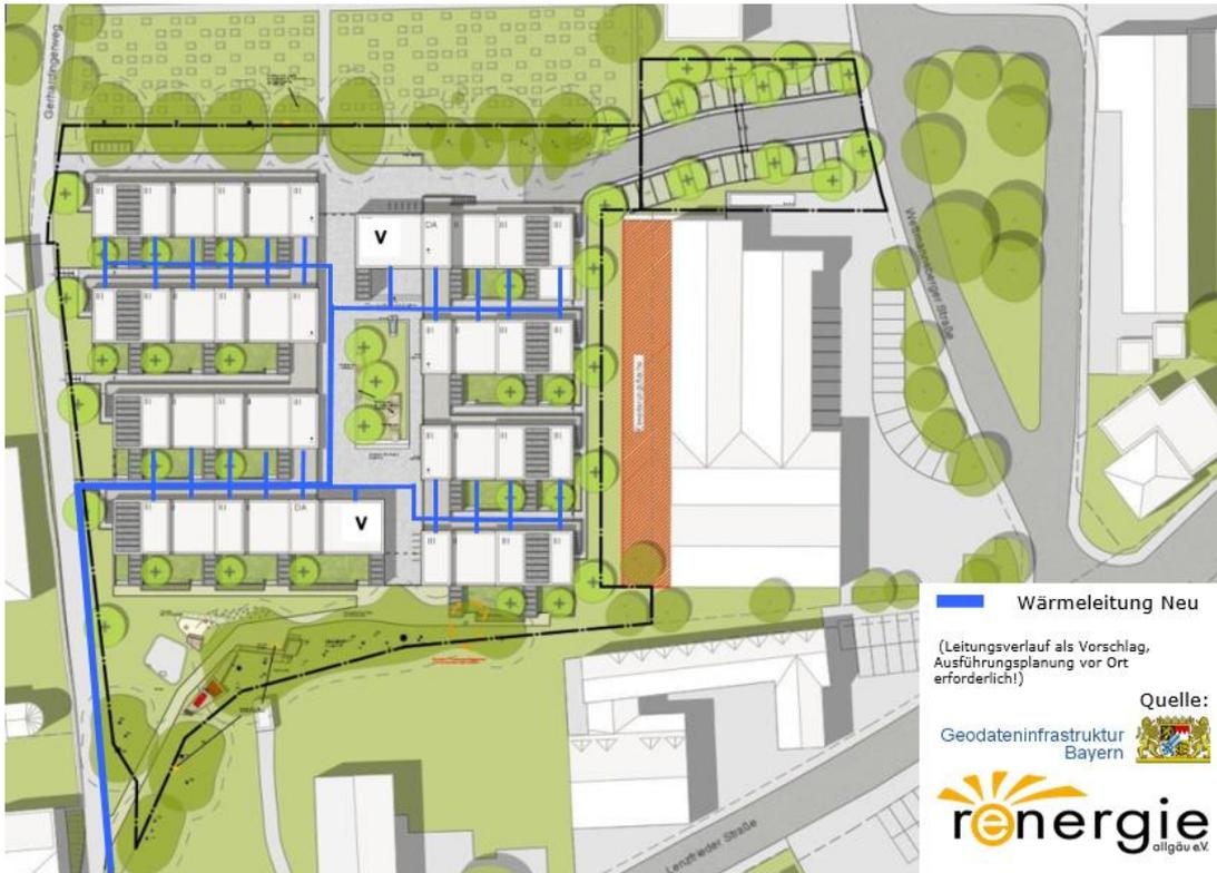
Abbildung 6 Detailansicht Leitungsschema Nahwärme Leupolz
