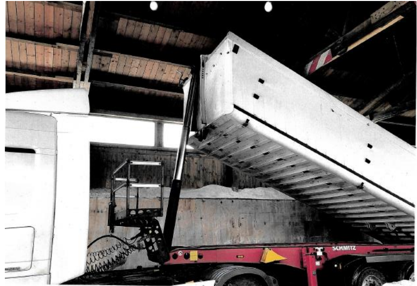
Problematische Befüllung der Hallen auf Grund der geringen Binderhöhe
