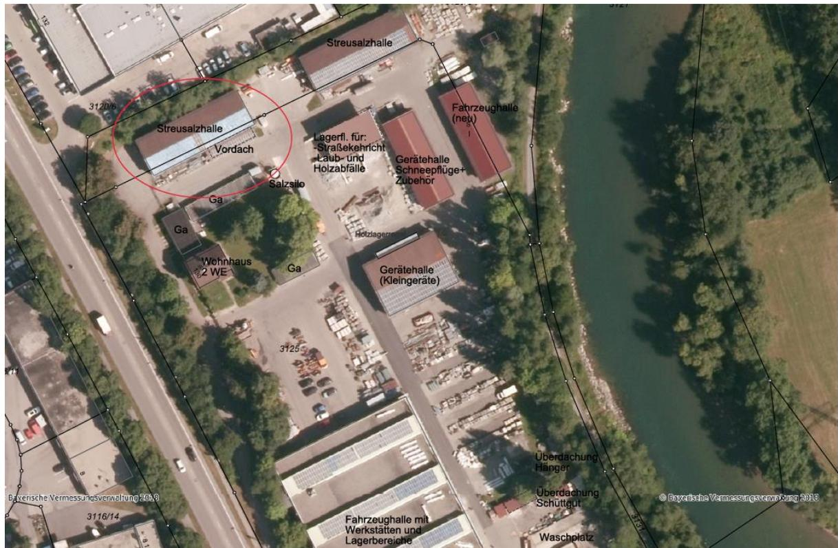
Die beiden Streusalzlagerhallen des Städtischen Betriebshofes wurden 1983 errichtet und weisen entsprechend den statischen Gutachten der LGA Kempten und des Ing.-Büro DSH Kempten zwischenzeitlich erhebliche Mängel an Fundamenten und den Stützeinsparungen auf.
