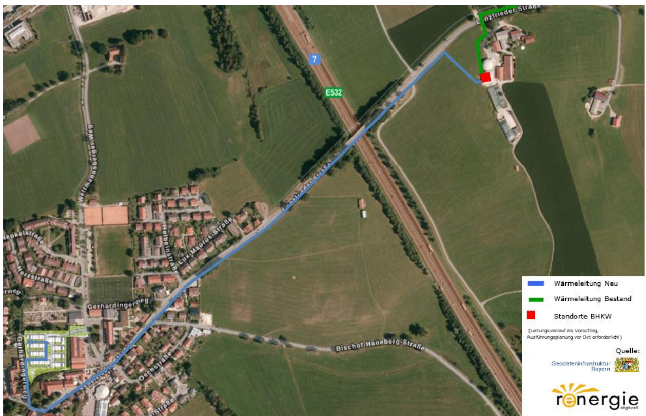
Abbildung 5 Leitungsschema Nahwärme Leupolz
