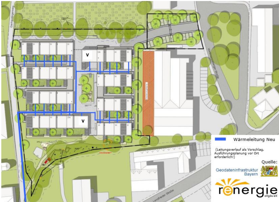
Abbildung 6 Detailansicht Leitungsschema Nahwärme Leupolz
