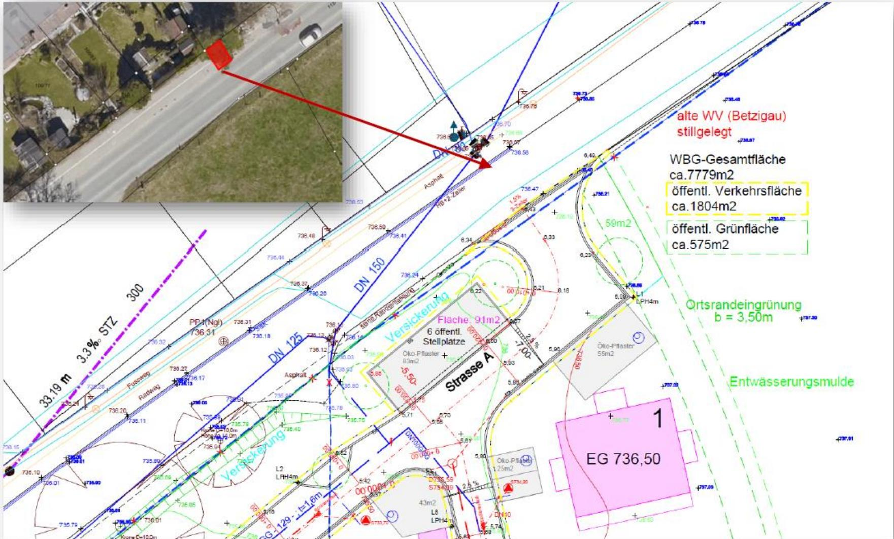
Grobumgriff der Absenkung des vorhandenen Bordsteines von der Bestandshöhe auf 3 cm Höhe auf einer Länge von ca. 5 m sowie Anpassung der Gehwegoberflächenbefestigung auf der gesamten Breite für die Anbindung an den Zweirichtungsradweg der Lenzfrieder Straße.
