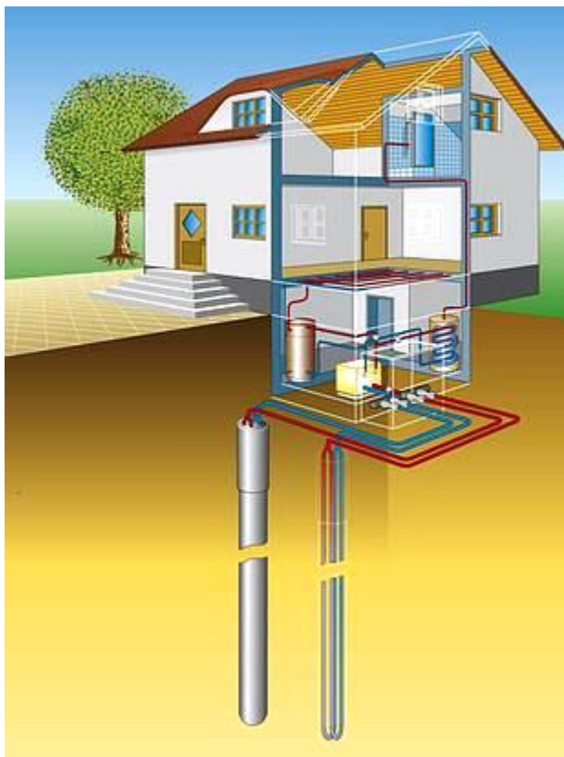
Abbildung 4.1: Schema WP mit Tiefensonde
