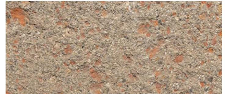
**Betonwerkstein mit Recyclingzuschlagsstoffen in zwei unterschiedlichen Farbtönen**
