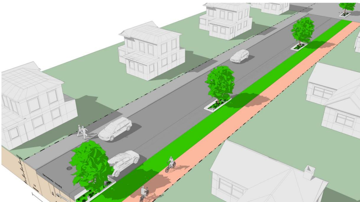
Abbildung 26: Regelprofil für Sammelstraße mit parallel verlaufendem Radweg (Perspektive)
